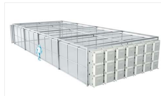
受賞したフローコーチEzp(スリープモード付き) 夜間、休憩、休日などの作業休止時には、スリープモード 運転に切替えてスライドスクリーン開口部を閉じ、クリーン ゾーン内部を陽圧状態に保ちながら消費電力をオープン 時の約70%カットすることができる
