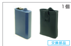
バッテリーケース BL 用 (カバー付き)※ 本体と電池を別ユニット化し、面体 部の軽量化を可能にします。 (BL-700HA / 200H 用) ※ BL-700HA にはバッテリーケース防滴 カバー BL 用が付属しています。
