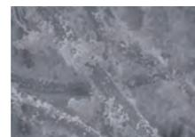
写真：フィルタに捕集された塗装ミスト。
