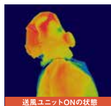
送風ユニットONの状態 頭部から首および腕部の温度が下がることが確認されました。
