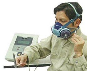
マスクフィッティングテスター MT-03 を使用した漏れ率測定
