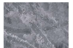
写真: フィルタに捕集された塗装ミスト。
