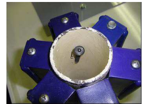
磁力線が配管内壁側に到達して、鉄製ビスが吸着している
