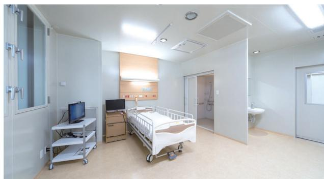
最新の設備が整備されている特定感染症病床。室内の空気は高性能のHEPAフィルタが設置された吸排気設備を通じて外部へ排気される
