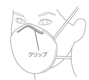
図1 鼻の形に合わせて形を変えるためのクリップ
