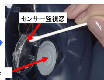
排気弁カバーのセンサー監視窓に付いた汚れを乾いた綿棒で拭き取ります。
