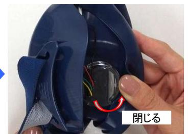
排気弁座に排気弁が確実に取り付けられていることを確認し、排気弁カバーを「パチン」と音がするまで確実にはめます。ゴムの接顔体を被せて、元に戻します。
