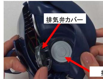
排気弁カバー(半透明)の突起部に指をかけて上方に持ち上げてカバーを開きます。
