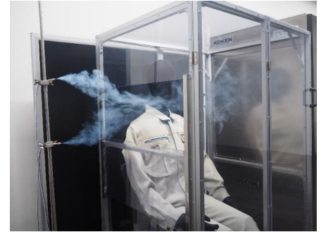
陰圧化され、内部へ吸い込まれる気流
