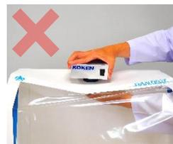
上蓋を閉じた状態で上から押し込むように取り付けると凹みが生じやすくなります。
