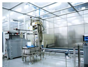
充填機からは発塵もあるため、汚れてもすぐに清浄度が回復するという点も高く評価
