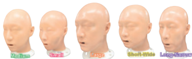
日本人向けフィットテストパネルに基づく各形状のソフトマネキン
