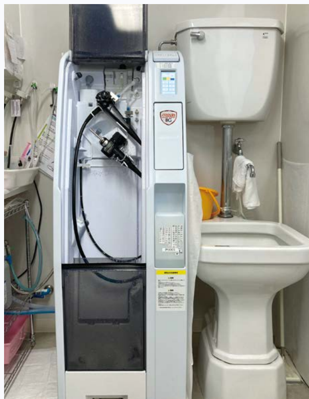
水道水と塩だけがあれば電解水の生成も行う鏡内侍IIG
