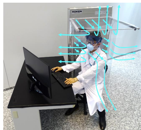
清浄空間の中にいながら、カルテ記入など外部へのアクセスが可能
